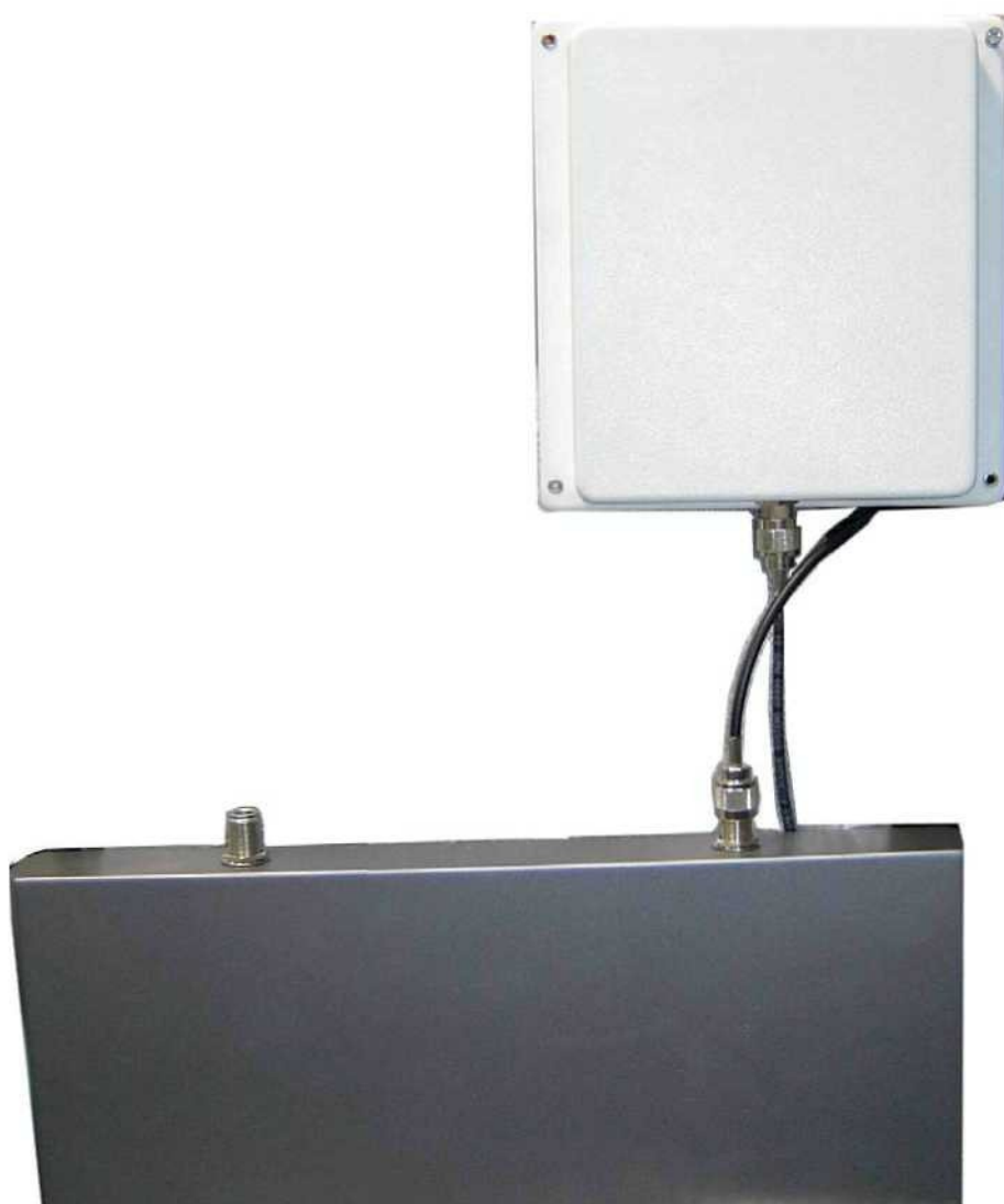
Рис. В-2: Установленные блок объединения и антенна
