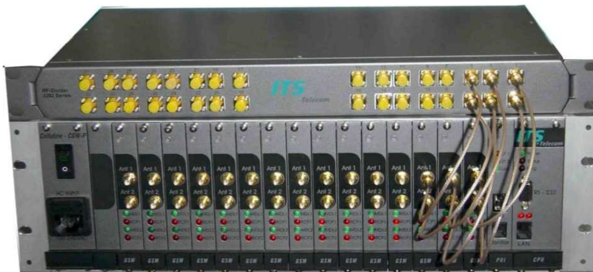
Рис. В-1: Передняя панель блока, подключенного к сотовым картам
